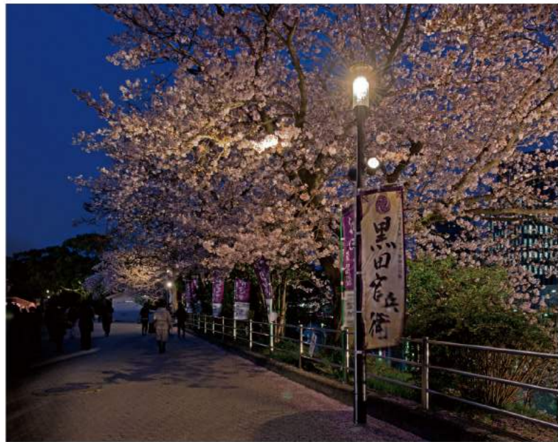
外構 特注ポール灯 BEGA H4555B+T4047B 光源：LED 40W×1 灯 +LED 26W×1 灯
