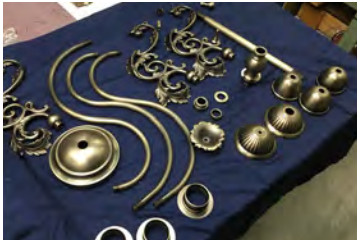
匠な技術をもつ工芸職人の手により、生まれ変わったパーツ。へら絞り加工、鋳物、複雑な板金加工を組み合わせることで従来品と全く遜色のないものを製作。
