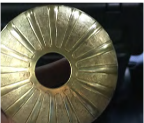
匠な技術をもつ工芸職人の手により、生まれ変わったパーツ。へら絞り加工、鋳物、複雑な板金加工を組み合わせることで従来品と全く遜色のないものを製作。
