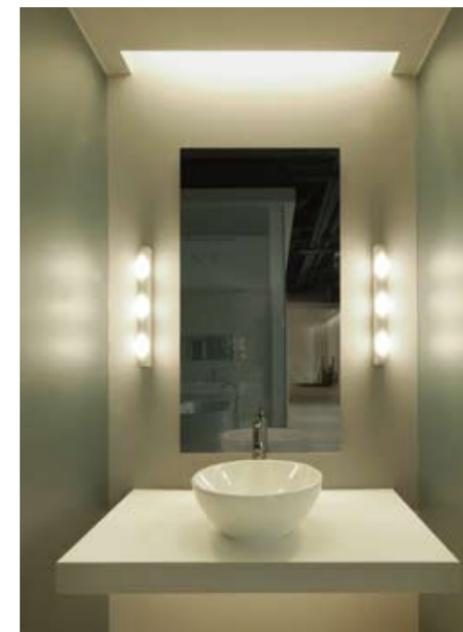
上部の間接照明が顔や壁面を明るくソフトに照らし白熱多灯ブラケットが肌を艶やかに見せます。フットライトの間接照明によりシンクが浮いて見えます。
