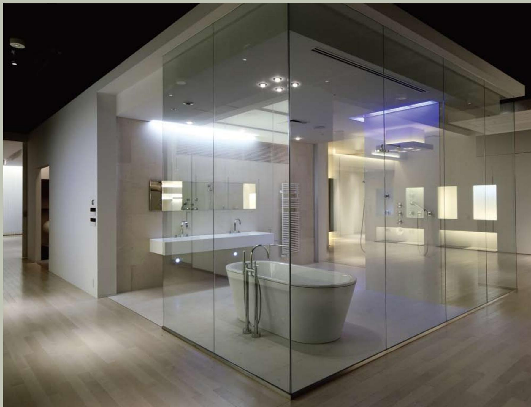
入浴のためのリラクゼーション効果をあげるため、最近の SPA などで行われている演出効果の高い照明手法を住宅に取り入れる方法をご紹介します。天井には超小型でガラスが美しいリンブルグの防湿型ダウンライトでベースの照度をとり、柱、シャワースペースを彩るカラーキネティクスの色光が赤系統から青系統の深い色合いに変化します。バスタブの横には埋込み型のアップライトを設置し、浴室の光の表情に立体感をもたらします。パウダールームのダウンライトと間接光の組み合わせも美しくトータルにくつろぎの空間を演出します。
