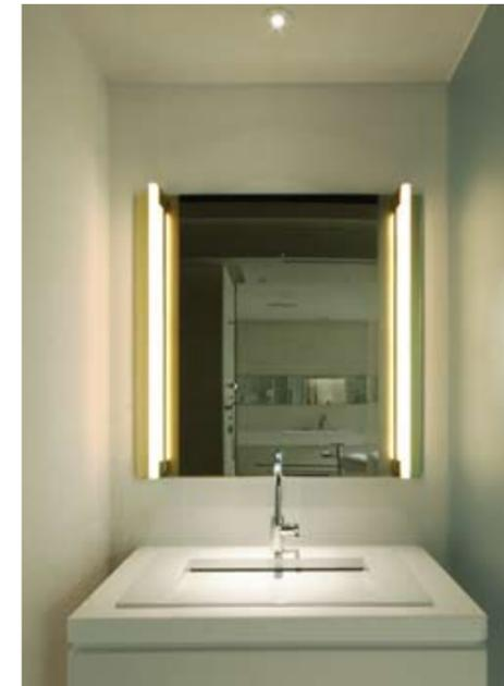
天井からのダウンライトの強い陰影を、ミラー横からのリネストラップの拡散光が和らげ、顔を美しく見せます。フットライトにより空間全体を軽やかに感じさせます。
