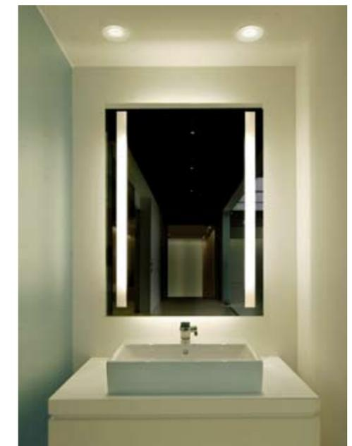
ガラス付きのダウンライトにより直射光と間接光の双方が得られ、ミラー裏に設置された蛍光灯により上下左右からの間接光が顔全体にひろがります。
