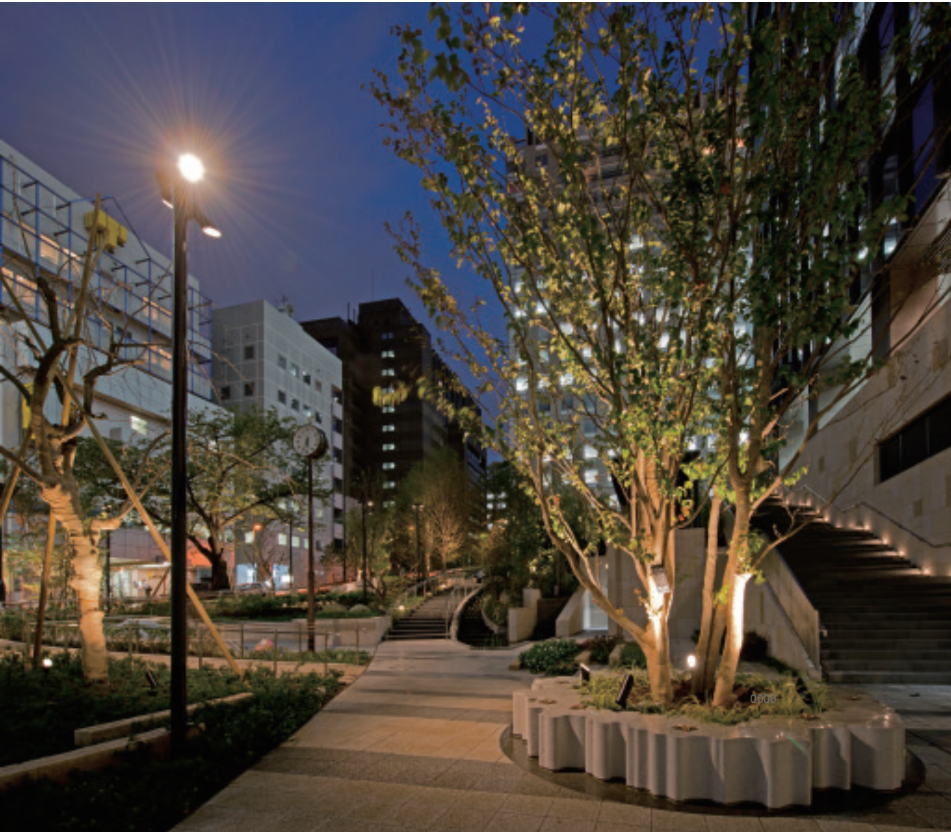
外構 特注ボール灯 X-series 光源：LED 22Wタイプ×3灯
