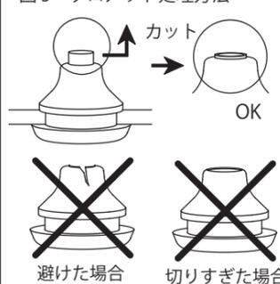
図6 電源線防水処理
