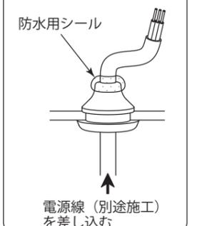
図 8 電源線 (別途施工)
