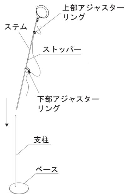
・支柱に下部アジャスターリングを通し、支柱の先端にストッパーを差し込んだ後、ステムを支柱に止まるまでしっかり差し込んでください。
