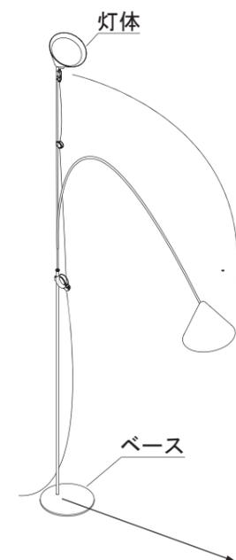
・灯体とベースは上図の方向に組み立ててください。反対方向に組み立てると転倒する恐れがあります。
