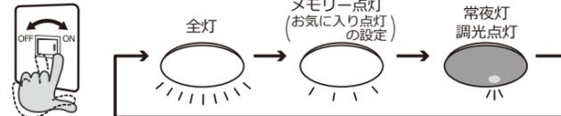
壁スイッチを素早く(約3秒以内に) OFF ⇒ ON を切り替えると上図のように点灯状態が切り替わります。
