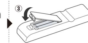
電池は⊖側接点をリモコンのバネに正しく押し当てながら装填する
