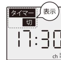
② **時刻設定** ボタンを短押しして「タイマー切」の設定時刻の表示を確認する
