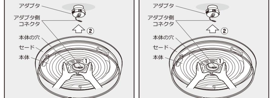
下図のように、アダプタ 2 段目のツメが見えるまで本体を押し上げる。
