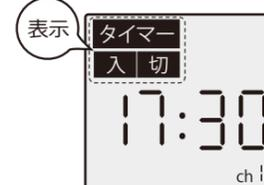
② **時刻設定** ボタンを短押しして「タイマー入」「タイマー切」の設定時刻の表示を確認する
