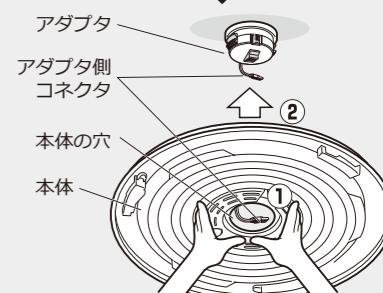
下図のように、アダプタ 1段目のツメが見えるまで本体を押し上げる。
