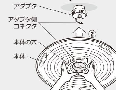
下図のように、アダプタ 2段目のツメが見えるまで本体を押し上げる。
