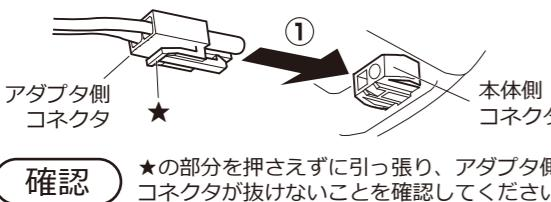
**確認** ★の部分を押さえずに引っ張り、アダプタ側のコネクタが抜けないことを確認してください。
