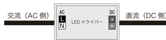
※コード長を変更する場合には0.75sq以上耐熱電線を使用してください。接続する際には適切な圧着端子等で確実に接続してください。
