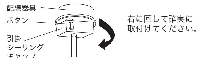
取り付け後にボタンを押さずに左に回し、外れない事を確認ください。
