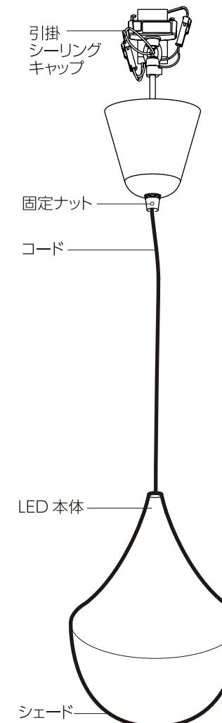
配線器具に引掛けシーリングキャップを確実に接続してください。
