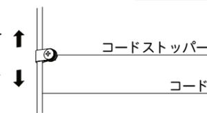
※コードの長さはコードに器具の荷重が掛からないように調整してください。コードに荷重が掛かりますと器具損傷の原因となります。
