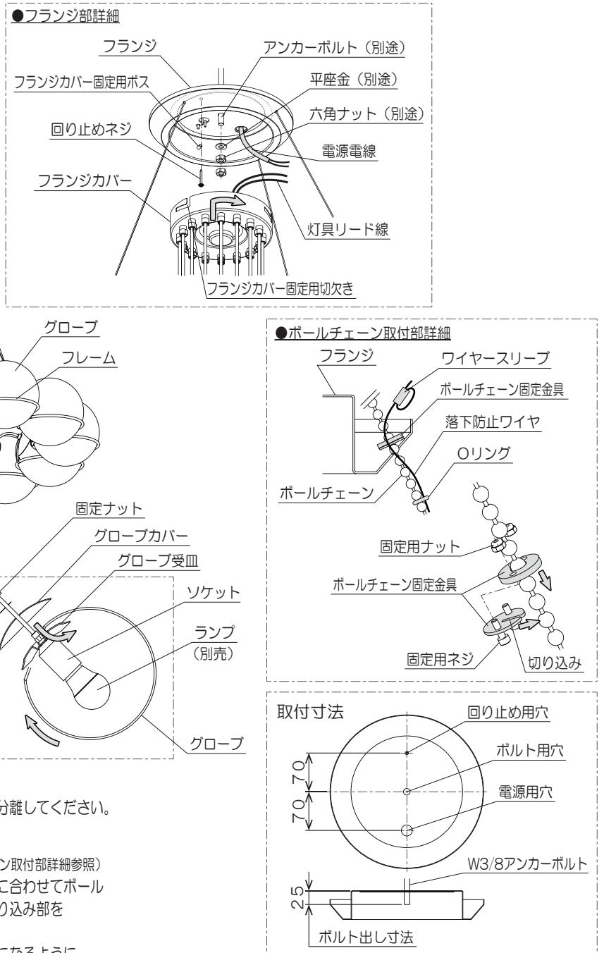
5. フランジカバーをフランジに取り付けます (フランジ部詳細参照)
