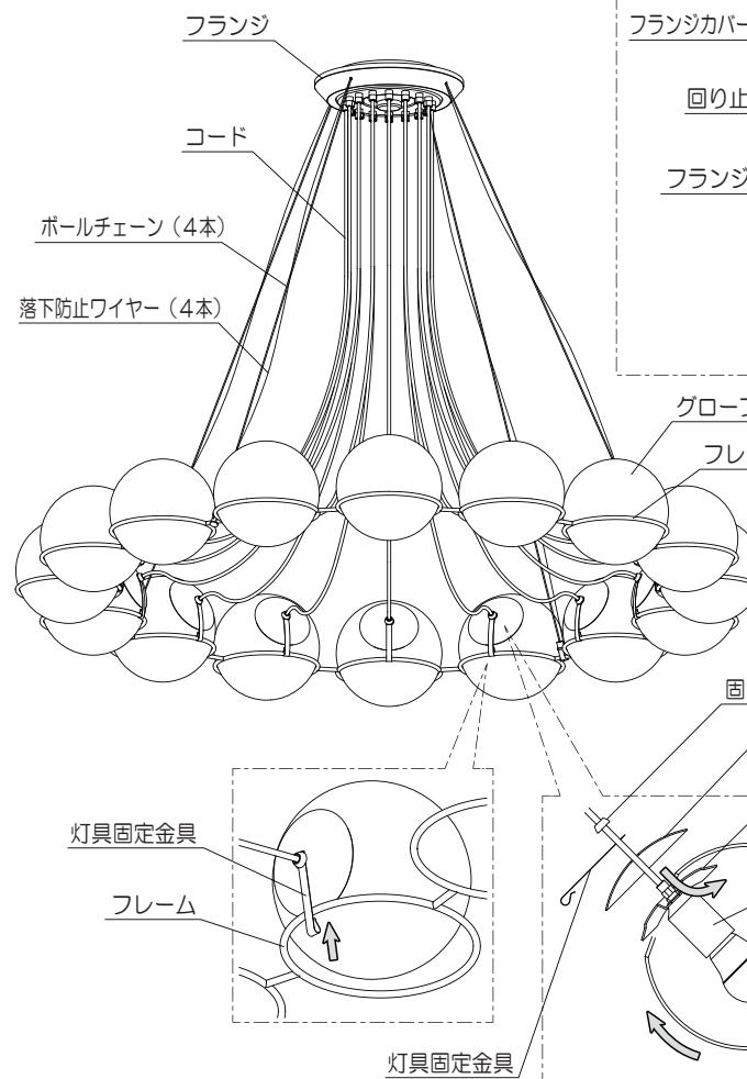
1. フランジカバーを左に回してから引き抜いて、フランジと分離してください。
