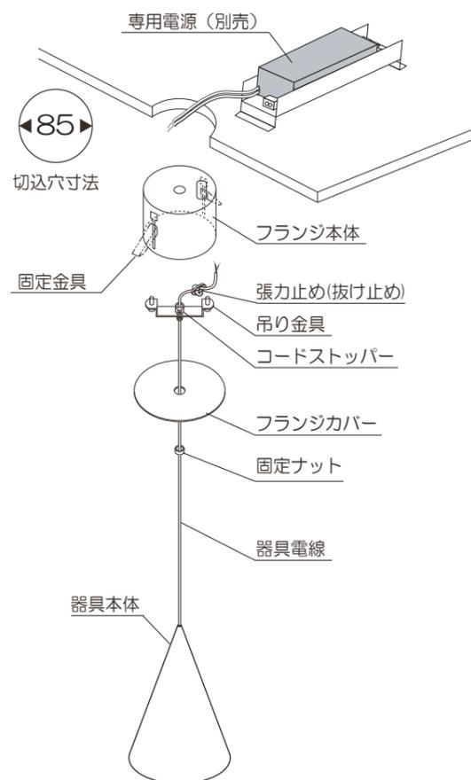
**注意** LED器具を直接AC100Vに接続すると、器具が故障します。必ず専用電源を使用して設置してください。その他、電源の取扱については電源付属の取扱説明書をご参照ください。
