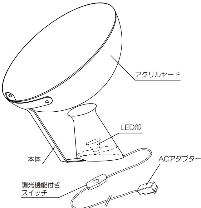
1. アクリルセードと本体を専用ナット（同梱）で2箇所下図のように取り付ける。
