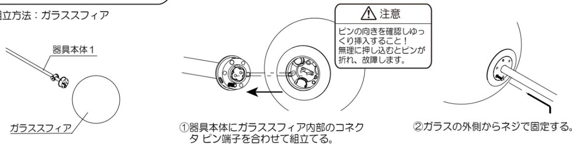
①器具本体にガラススフィア内部のコネクタピン端子を合わせて組立てる。
