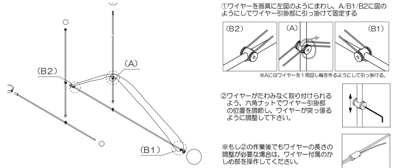
②ワイヤがたわみなく取り付けられるよう、六角ナットでワイヤ引掛部の位置を調節し、ワイヤが突っ張るように調整して下さい。
