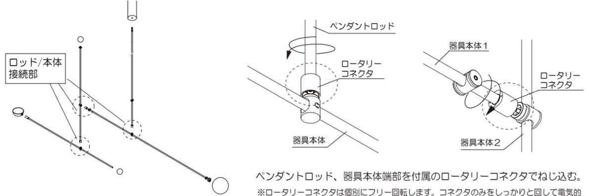
ペンダントロッド、器具本体端部を付属のロータリーコネクタでねじ込む。
