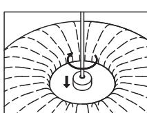
3) セードのバランスが取れたらバランス調整金具を締めて固定します
