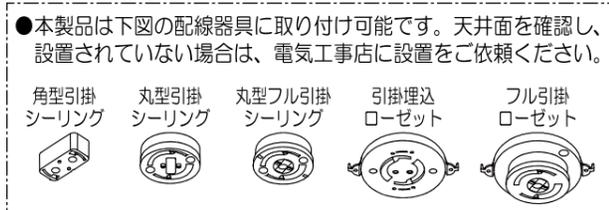
●本製品は下図の配線器具に取り付け可能です。天井面を確認し、設置されていない場合は、電気工事店に設置をご依頼ください。
