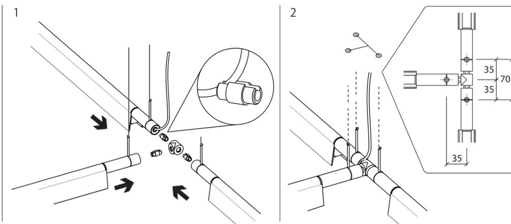
連結パーツ（131Z1273、131Z1274）（別売）を使用して、通電していない端子どうしに差し込みます。水平、垂直を確認しながら吊りワイヤの長さを調整してください。
