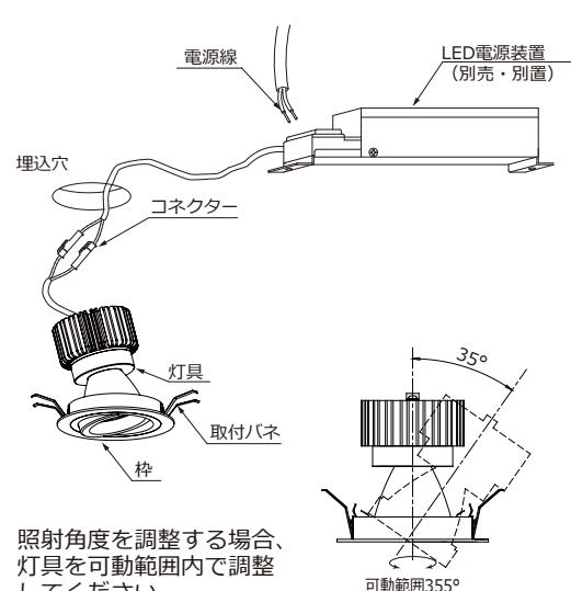
△ 指定の可動範囲以上、無理に可動させないでください。器具破損、器具落下の原因となります。
