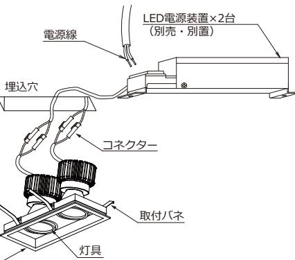
照射角度を調整する場合、灯具を可動範囲内で調整してください。
