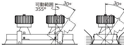
△ 指定の可動範囲以上、無理に可動させないでください。器具破損、器具落下の原因となります。
