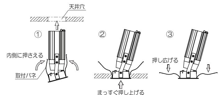
※器具を設置する際は照射方向（上図「配光イメージ」参照）を確認したうえで、照射面（壁面）に対して、正しく器具をセットしてください。
