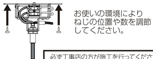
ねじ止めをする取付面の裏側に補強材をあてて、施工してください。
