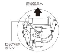
形状を合わせて 配線器具に端子を差し込み、 時計回りに回して取り付けます。
