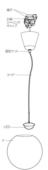
配線器具に引掛けシーリングキャップを 確実に接続してください。
