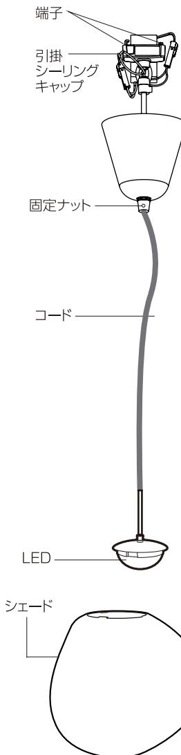
配線器具に引掛けシーリングキャップを確実に接続してください。
