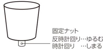
※固定ナットは確実に締めてください。固定ナットがゆるんでいると商品が落下する恐れがあります。
