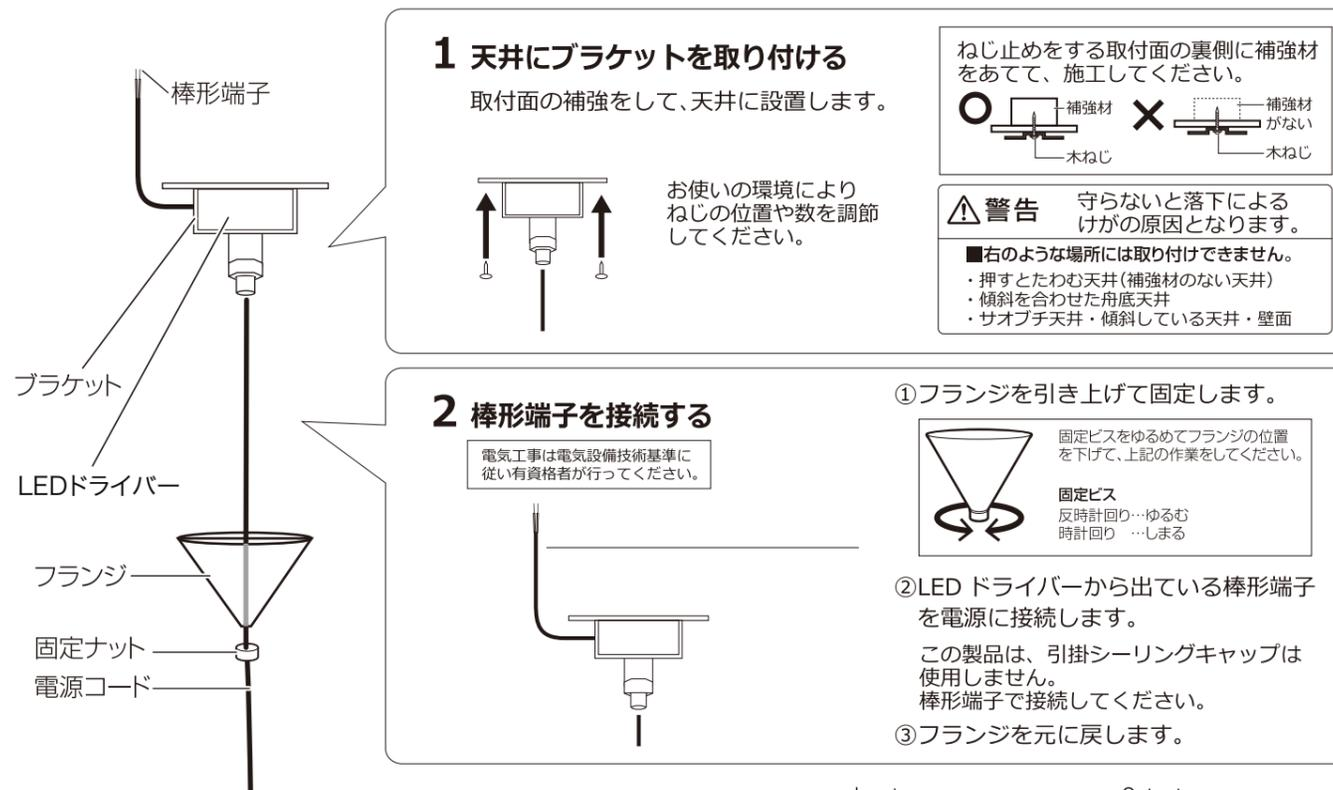
本商品は専用のLEDドライバー（直流電源装置）を使用して点灯します。コード長を調整する際には配線の間違いが無いよう十分にご注意ください。
