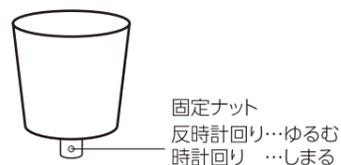
※固定ナットは確実に締めてください。固定ナットがゆるんでいると商品が落下する恐れがあります。
