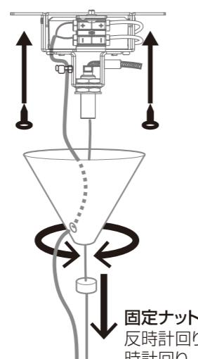
取付面の補強をして、天井に設置します。
