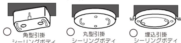
●上図の引掛シーリングボディが付いていない場合は、専門の電気工事店へ引掛シーリングボディ取付電気工事をご依頼ください。電気工事の際は十分な長さの取付ネジ2本で天井の補強材のある位置に取り付けてください。
