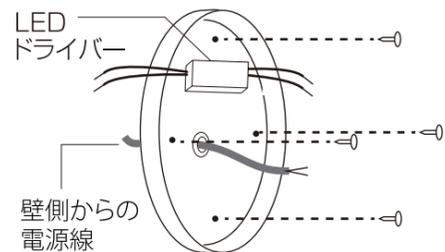
②電源接続棒端子を電源へ接続します。
