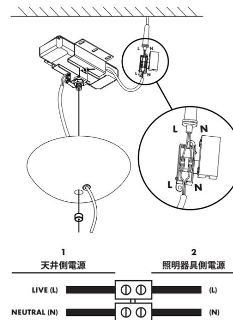
**7** A フランジを戻します。 B 固定ナットを締めます。
