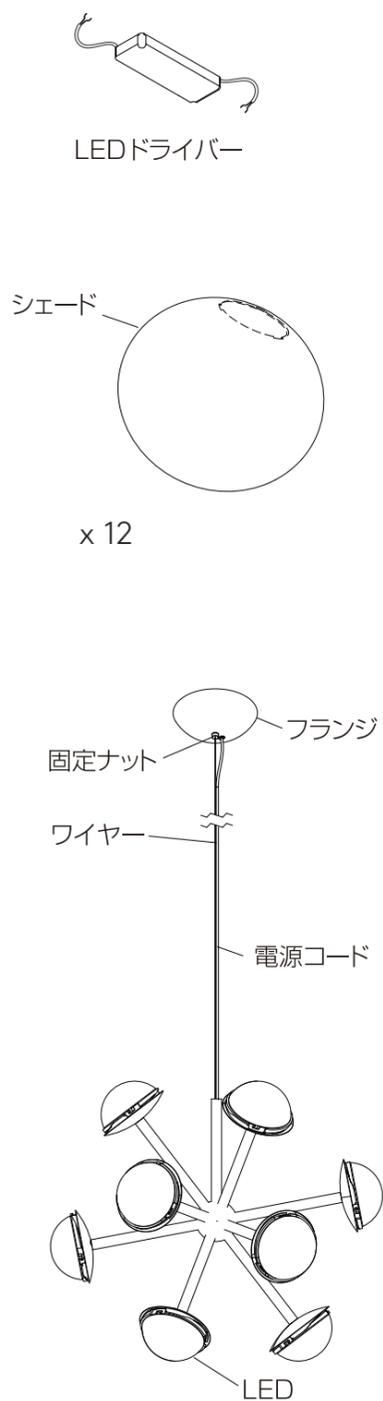
**1** A 固定ナットを外します B フランジを下ろします。
