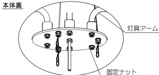
6. 本体に結線カバーおよび飾りカバーをかぶせ、樹脂ワッシャーをセットし、押えナットで確実に固定してください。さらに押えフタを飾りカバーにセットし、飾りカバー止めナットで固定してください。（左図参照）
