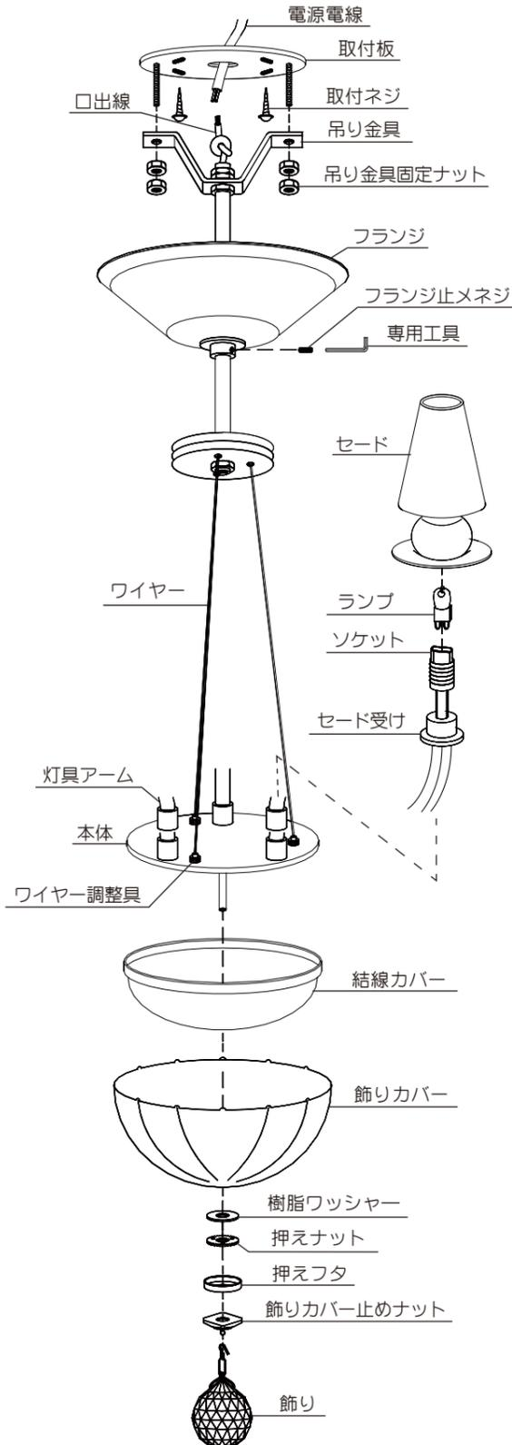
1. 取付板を付属の取付ネジ（4本）で補強材のある位置に取り付けてください。（左図参照）
