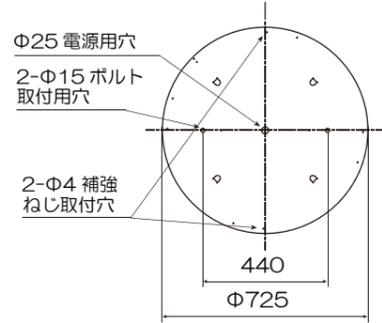
取付板外形寸法及びボルト出し寸法(単位mm)
