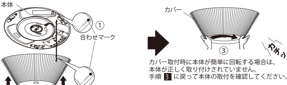
**確認** カバーが確実に取付けされていることを確認してください。
