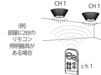
リモコンのチャンネルを切り替えると、1台のリモコンで複数の本体が操作できます。
