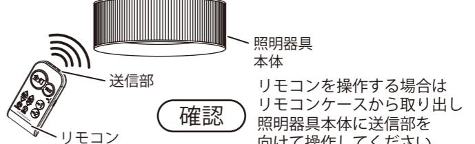
リモコンを操作する場合はリモコンケースから取り出し照明器具本体に送信部を向けて操作してください。
