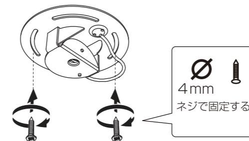
ねじ止めをする取付面の裏側に補強材をあてて、施工してください。
