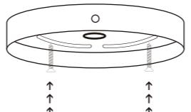
ねじ止めをする取付面の裏側に補強材を
