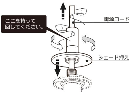
**!** シェード押えを強く締め付け過ぎると器具の破損の恐れがあります。
