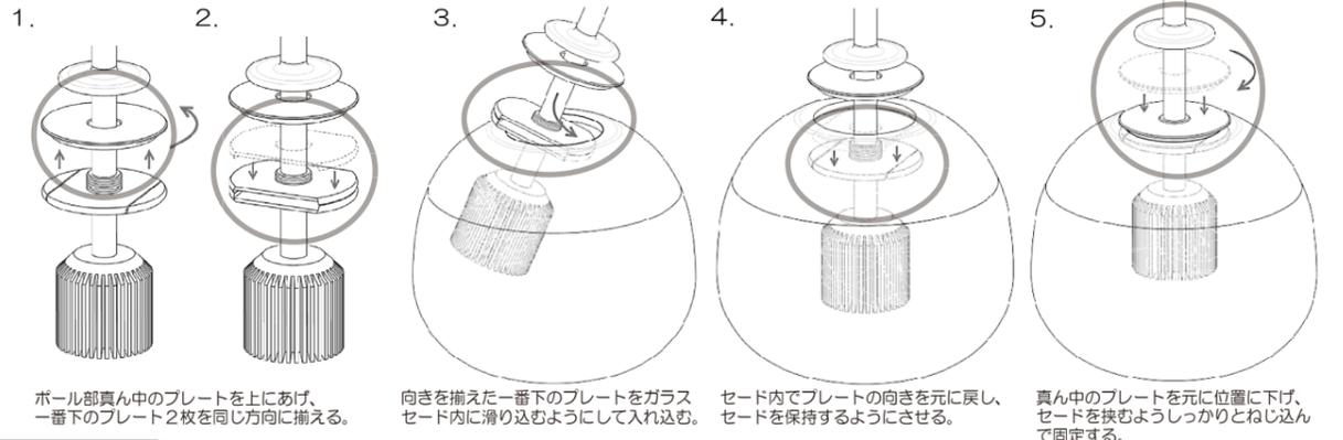
ボール部真ん中のプレートを上にあげ、一番下のプレート2枚を同じ方向に揃える。 向きを揃えた一番下のプレートをガラスセード内に滑り込むように入れて、セード内でプレートの向きを元に直し、セードを保持するようにさせる。 真ん中のプレートを元位置に下げ、セードを挟むようしっかりとねじ込んで固定する。
