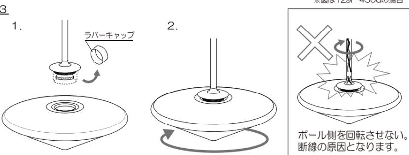
注) ネジ留めの際は必ずセード側を回してください。本体ボールを回転していくと内部リード線が引きちぎれて、故障の危険があります。
