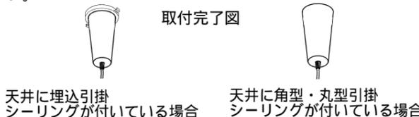
下図のように本体を上へあげ、ソケットにランプをセットし本体を元の位置に下げます。（指定ワット数以下のランプをご使用ください。）
