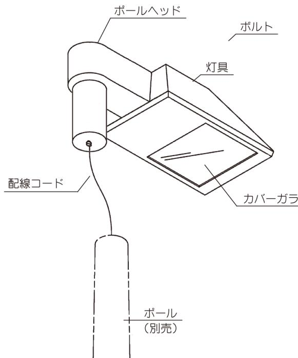
2. ポールヘッド止メネジ、六角穴つきボルトを締め付け、
