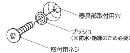
図4 取付ネジ部分の防水処理
