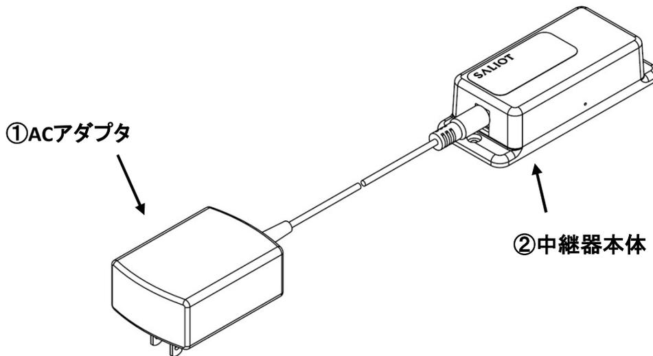
1. ①ACアダプタのDCプラグを②中継器本体の電源ジャックに接続します。
