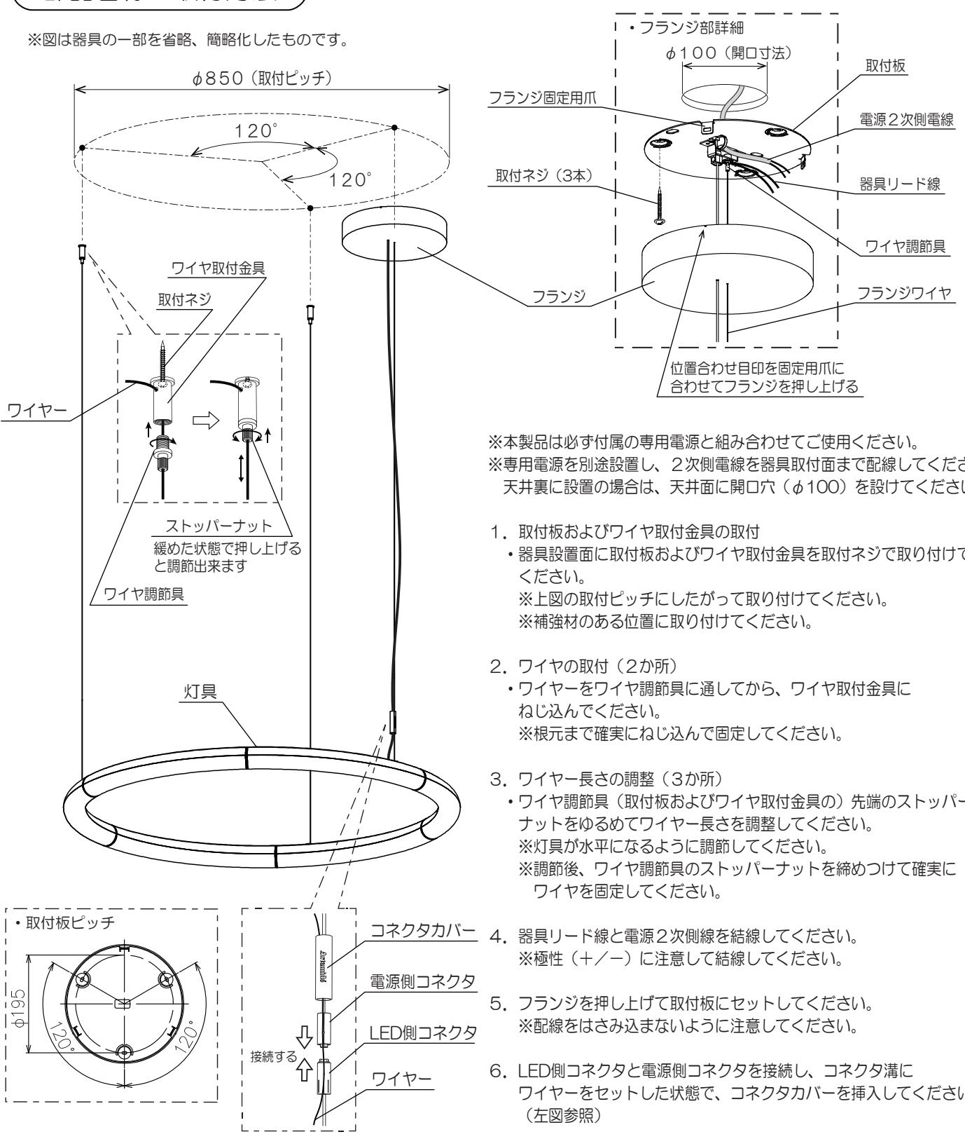
1. 取付板およびワイヤ取付金具の取付
