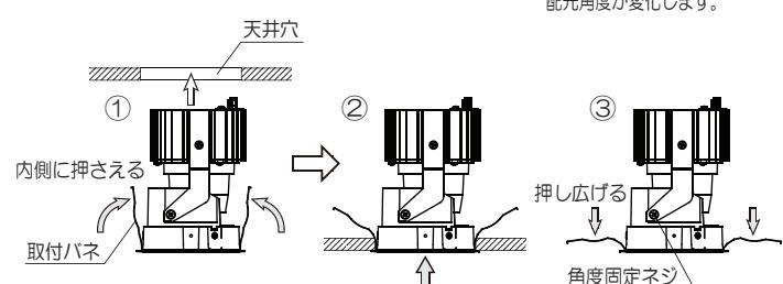
※角度調節の際、角度固定ネジが緩み、任意の角度で固定できない場合は、角度固定ネジを増し締めしてください。
