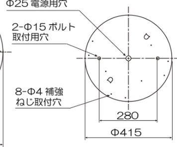
取付板外形寸法及びボルト出し寸法(単位:mm)
