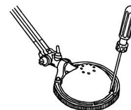
左図のように器具の前方のツメとセードの間にマイナスドライバーを差し込み、ツメからセードを外し、ランプを交換します。
