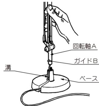
上図のように器具の軸を支え、回転軸AをガイドBが、ベースの溝に沿うような向きで、ベースに差し込みます。
