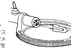
左図のようにランプのピンを曲げないように注意してランプソケットに差し込んでください。このとき素手でランプの表面に触れないよう注意してください。ランプ表面が汚れた場合はアルコール等でふき取ってください。
