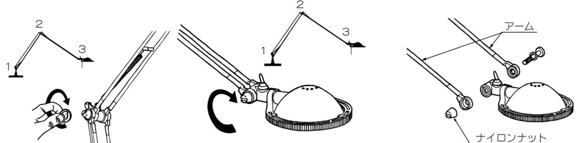
バランスの調整は、3ヶ所のナイロンナットの締め付けを調整してください。
