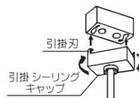
2. フランジを天井まで押し上げ、フランジ固定キャップをしめて固定してください。
