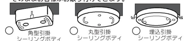
●上図のシーリングボディが付いていない場合は、専門の電気工事店へご依頼ください。引掛シーリングボディ取付電気工事の際は十分な長さの取付ネジ2本で天井の補強材のある位置に取り付けてください。
