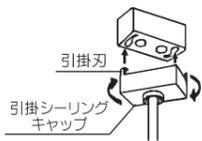
6. フランジを天井まで押し上げ、ワイヤ調整具キャップをしめて固定してください。
