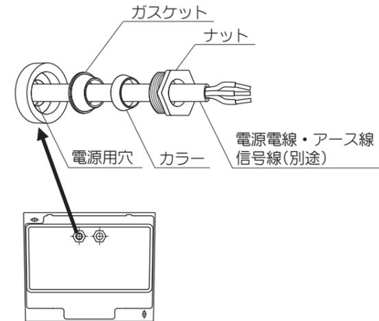
1. 電源用穴に電源電線、アース線、信号線(別途)を通します。(図3)
